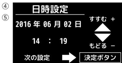
⑤ 年から月、日、時、分の順で変更箇所に移りますので、④と同様に正確に設定します。なお、分の設定時、「+」または「-」ボタンを1回押すごとに1分動きますが、長押しすると10分単位で動きます。
